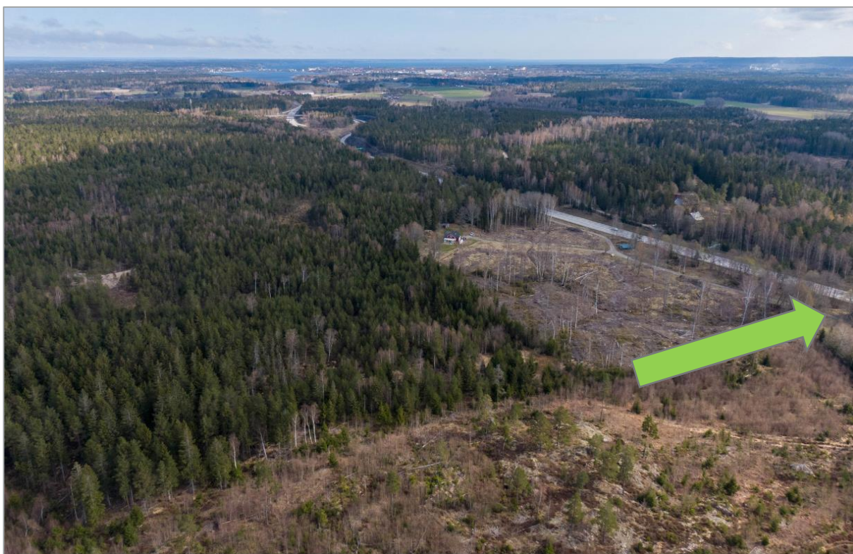
Figur 14. Drönbild mot norr med E45 österut. Aktuellt område består av skogsmark och avverkad skogsmark. Grön pil anger ytavrinning mot trummor under E45 (Foto Norconsult, Oliver Willskytt).
